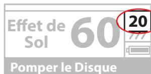
Le réglage d'effet de sol varie de 0 à 99. Pourtant, chaque chiffre comprend 5 étapes utilisées pour affiner, ces étapes sont affichés sur l'écran LCD au-dessus du symbole **777** et sont des multiples de 20. Par exemple, la valeur d'effet de sol sur l'écran sur le côté est 60.20.
