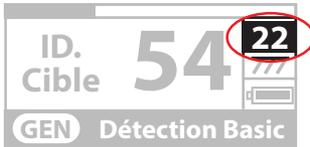
Le niveau de Minéralisation Magnétique varie de 0 à 99, et est affiché sur l'indicateur de Minéralisation Magnétique, sur la partie droite de l'écran principal. Cette mesure peut être résumée par le niveau de la propriété et de l'intensité magnétique du sol. Simplement, si vous travaillez sur un terrain avec des minéraux intenses et magnétiques, cette valeur sera haute. Si le sol n'est pas très magnétique, cette valeur sera basse.
