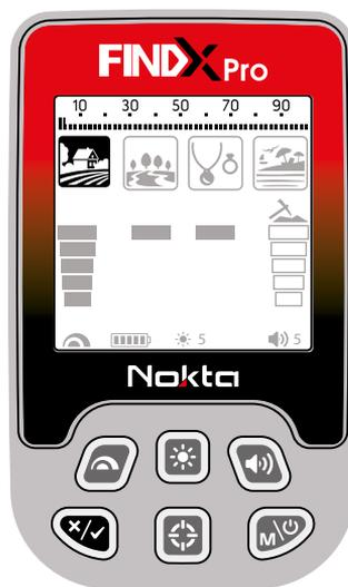
A configuração de Discriminação de Notch é restaurada para a última configuração salva quando o dispositivo é ligado e desligado novamente. Essa configuração é específica para o modo; as alterações feitas em um modo não se aplicam aos outros modos.
