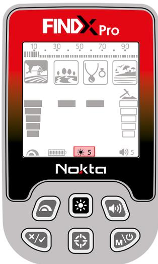
Varia de 0 a 5 e de 6A a 10A. No nível 0, a retroiluminação do visor e do teclado está desligada. Entre 1 e 5, permanece continuamente ligada. Quando ajustado entre 6A e 10A, acende apenas por um curto período quando um alvo é detectado ou um botão é pressionado e, em seguida, desliga.
