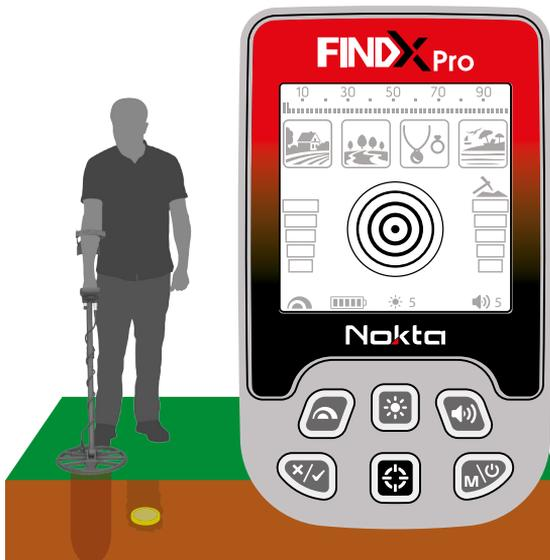
2) Mantenha o botão pressionado e aproxime a bobina sensora do alvo lentamente e paralelamente ao solo.
