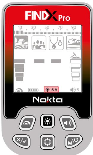
Para alternar da iluminação contínua para o nível de iluminação automática, basta continuar pressionando o botão de retroiluminação do visor LCD e do teclado. A operação contínua da retroiluminação afetará o consumo de energia, o que não é recomendado. A configuração da luz de fundo é restaurada para a configuração final salva quando o dispositivo é desligado e ligado novamente. Essa configuração é comum em todos os modos; a alteração feita em qualquer modo também se aplica aos outros modos.
